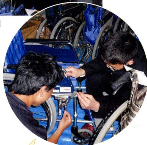
「ボルトのゆるみやタイヤの空気圧など細かく点検していきます。」
